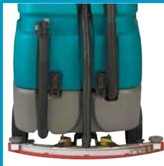
**No deje rastro alguno de la solución de limpieza a su paso**, incluso alrededor de giros de 180 grados, con la presión equilibrada del modelo T7 y el recuperador de agua parabólico.
