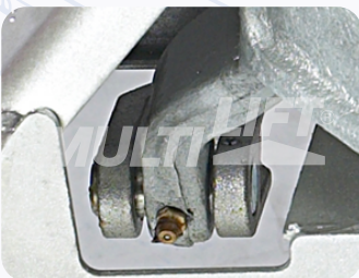
Graseras de lubricación en puntos clave.
