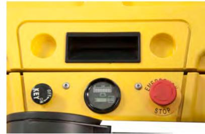
Horómetro, indicador de descarga de batería y botón de paro.
