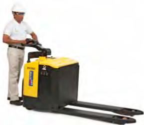
Dirección hidráulica y barra de Soporte que incluye controles de velocidad, ascenso y descenso. 6.6
